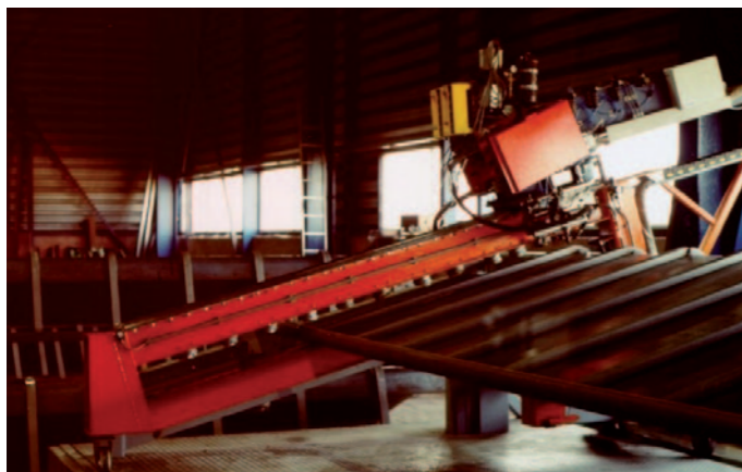
Figuur 3 Af te lassen containerwand op de lasinstallatie
